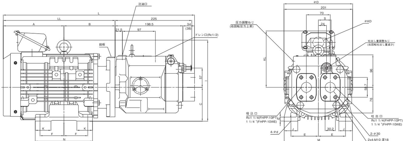
(注) 外觀寸法で( )内は溶接フランジ使用時の寸法を示し( )なしはRcねじフランジ使用時の寸法を示します。
