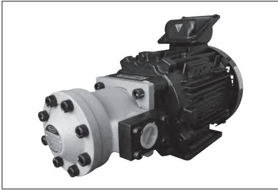
このポンプは電動機に直接ポンプを取付け一体化にしたものです。ポンプと電動機の取付台の加工や、軸の芯出し作業がいりません。
