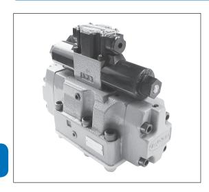
この弁は電磁切換弁と油圧切換弁を結合した切換弁で、電磁切換弁により制御されるパイロット圧力により油圧切換弁(主弁)を操作し、主回路の圧油の流れ方向を切換えます。
